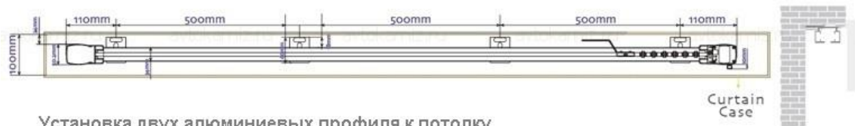
Установка двух алюминиевых профиля к потолку
