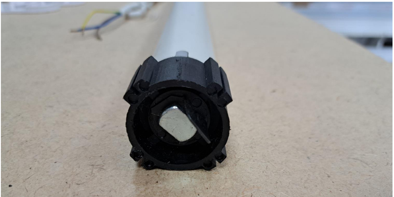
Рис. 2-4 Взять «стопор» и при помощи плоскогубцев установить на вал мотора и повернуть на 90 град.
