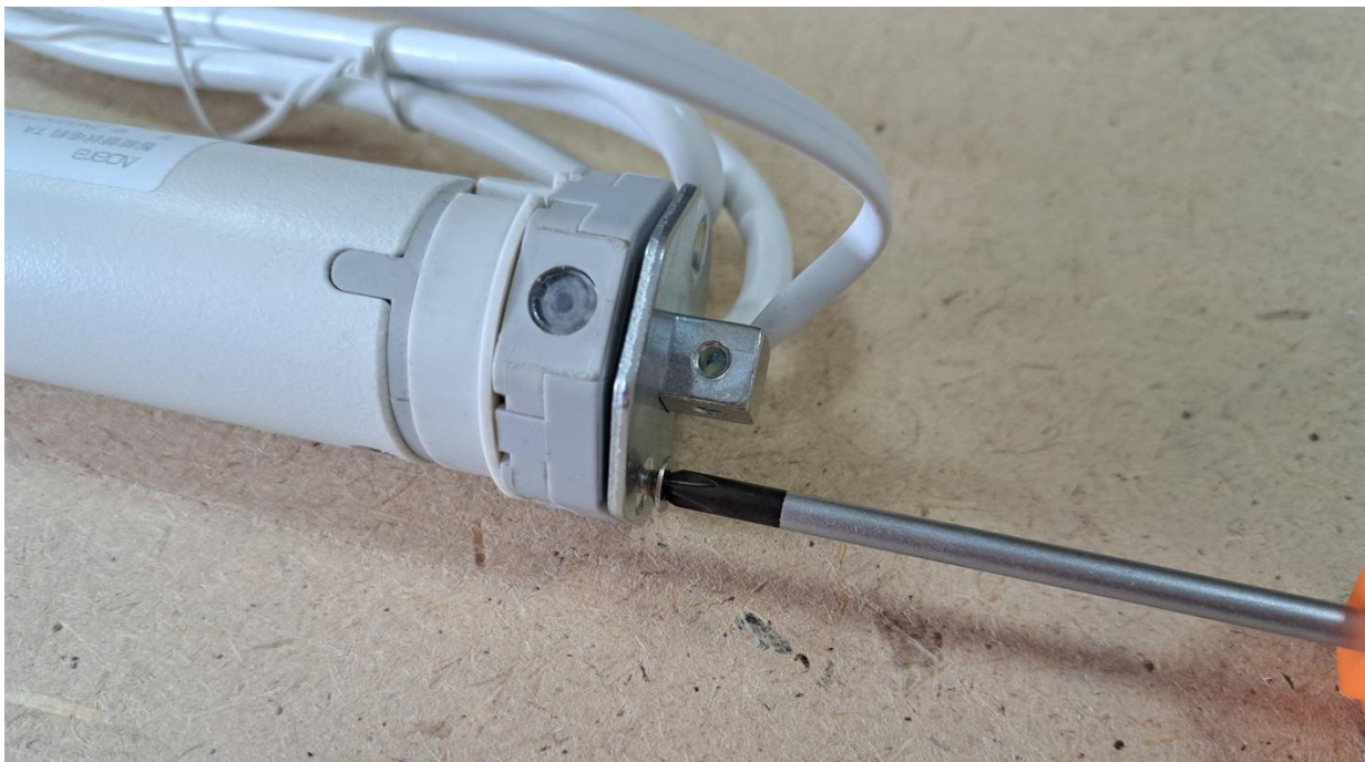
Рис. 7-8 Снять пластину и вал (квадрат) с мотора. Открутить 2 винта отверткой.
