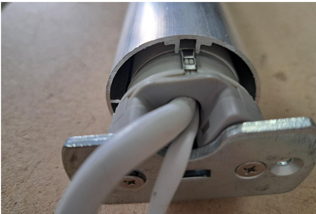
Рис. 10 -11 Установить мотор в трубу
