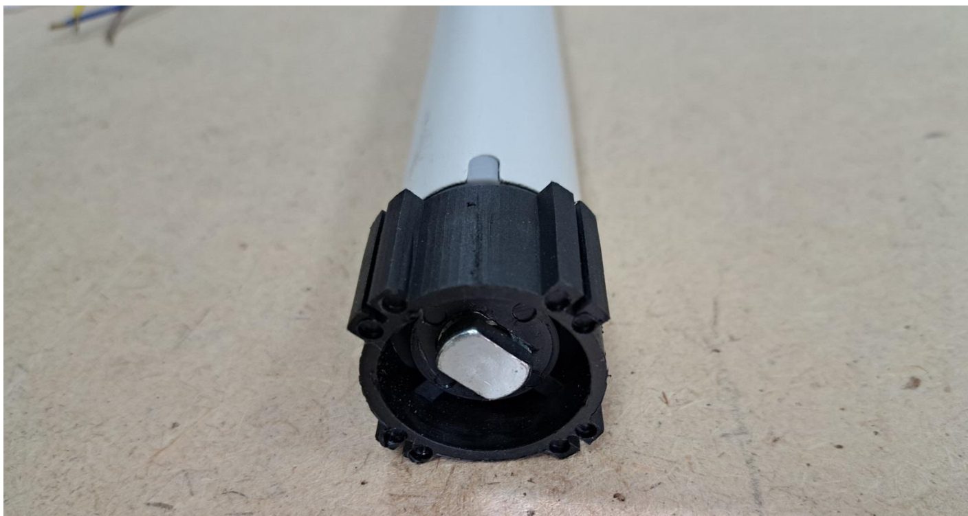
Рис. 1 Установить на мотор «Адаптер для вала»
