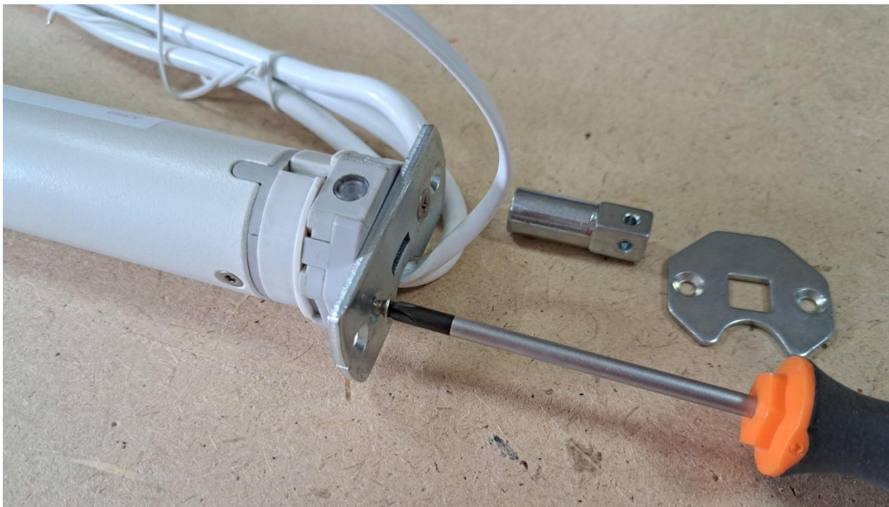
Рис. 9 Установить метал. пластину 2-мя винтами.
